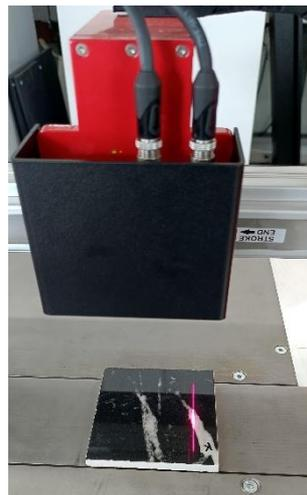
Figura 32. Detalle del sensor 3002 de MICROEPSILON midiendo sobre pieza marmoleada.
