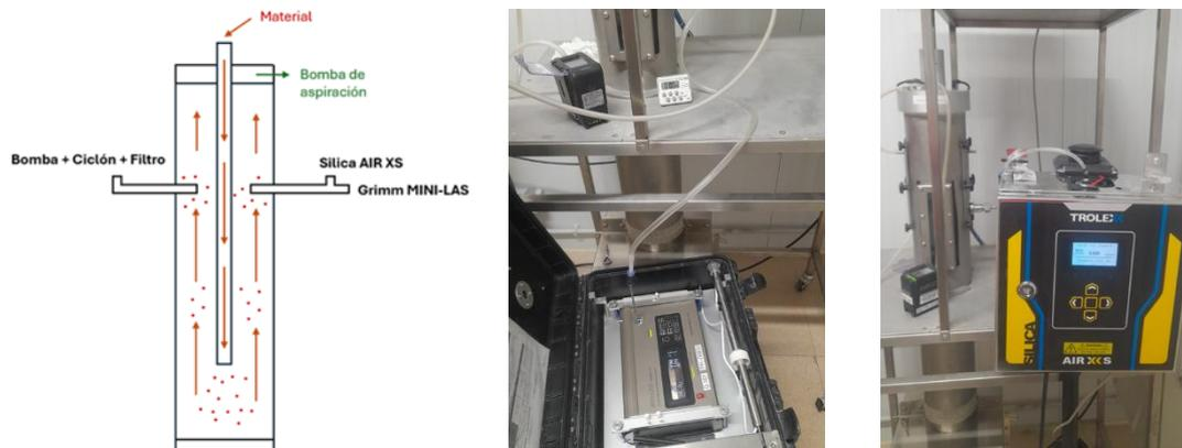
Figura 67. Montaje experimental para la verificación y comparativa del Silica AIR XS en el ensayo de caída continua
