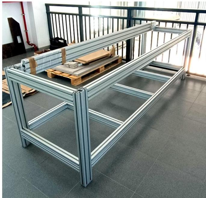
Figura 60. Estructura en perfilaría de aluminio del demostrador de medida de dimensiones y defectos.
